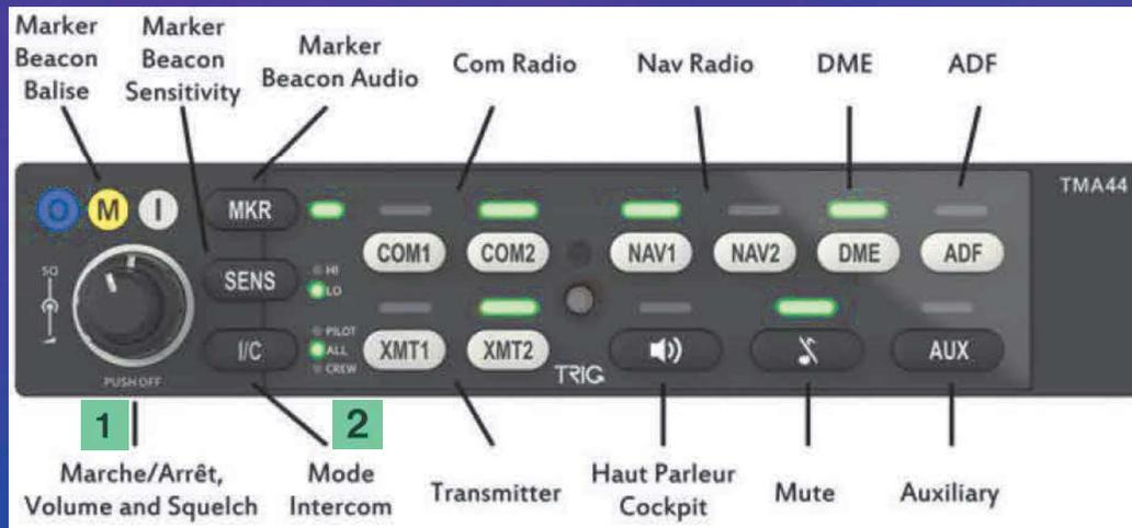
**1**: Contrôle le squelch ou volume de l'intercom des 4 places en même temps, cela n'a pas d'effet sur le volume de la radio.
