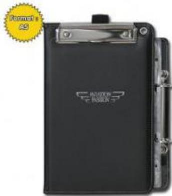
La planchette de vol qui se fixe autour de la cuisse est un accessoire de confort nécessaire pour effectuer la conduite du vol dans de bonnes conditions. Elle permet de faire le suivi du log de navigation au fur et à mesure du vol, de prendre des notes sur les informations transmises par le contrôle aérien. Certains modèles avec pochettes plastiques intégrées permettent de ranger les cartes d'approches des aérodromes.
